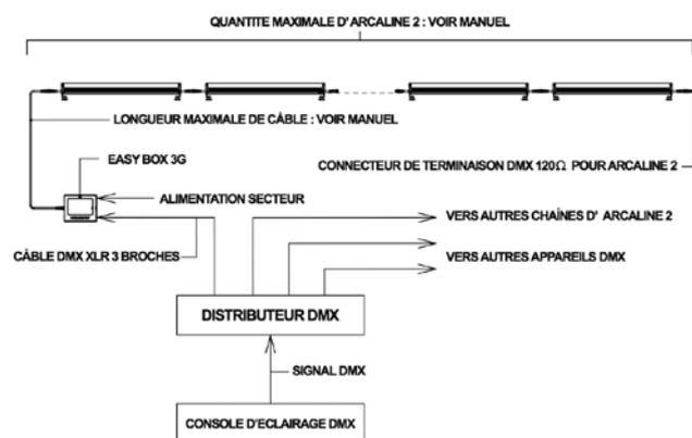
L'ARCALINE2 3G dispose d'une alimentation interne universelle, il peut donc fonctionner indifféremment en 110V AC, 208V AC ou 230V AC.
