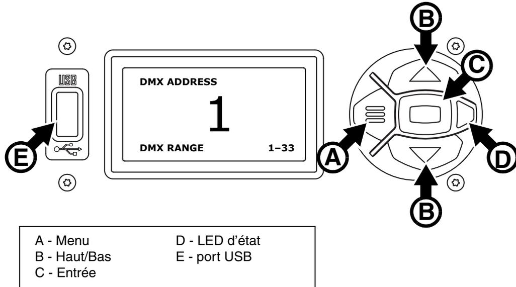
Figure 5: Panneau de contrôle et afficheur
